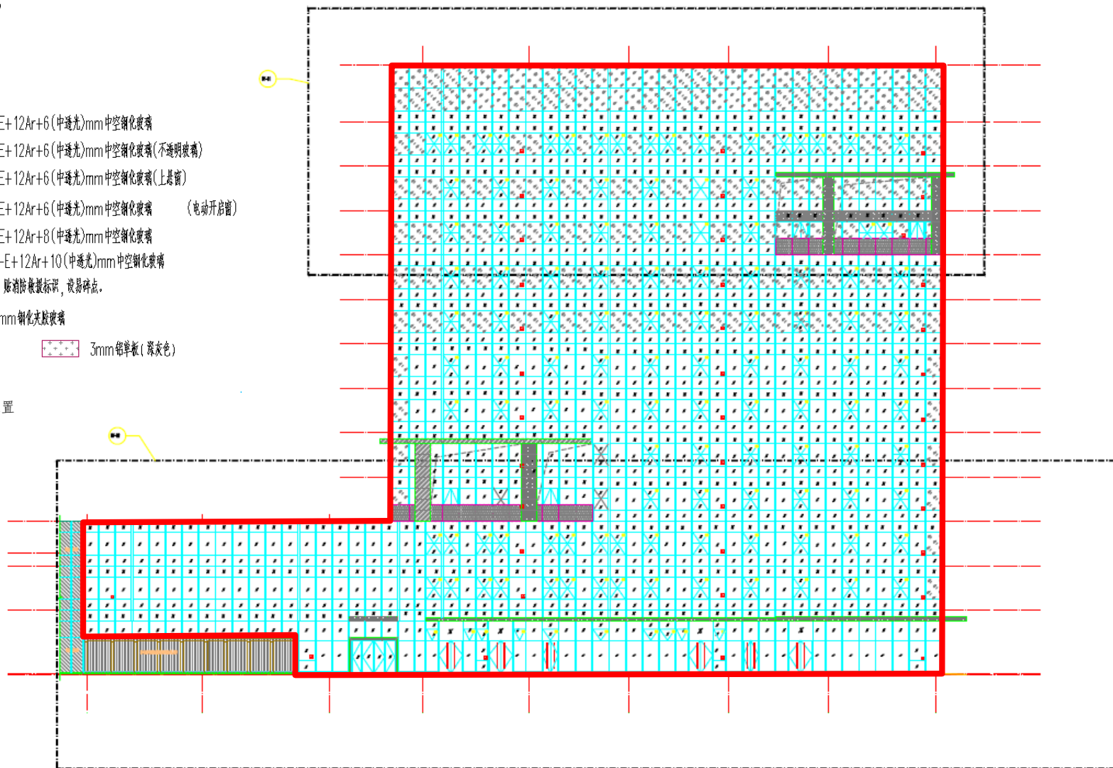
图 1.7-4 28-A 号楼西立面幕墙图
